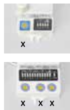
Forklaring af nummerkombination for master- og slavearmaturer på billede 4.
