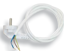
Sladdställ, 2 m H05VV-F (RKK) 3G1,0 mm 2 .
